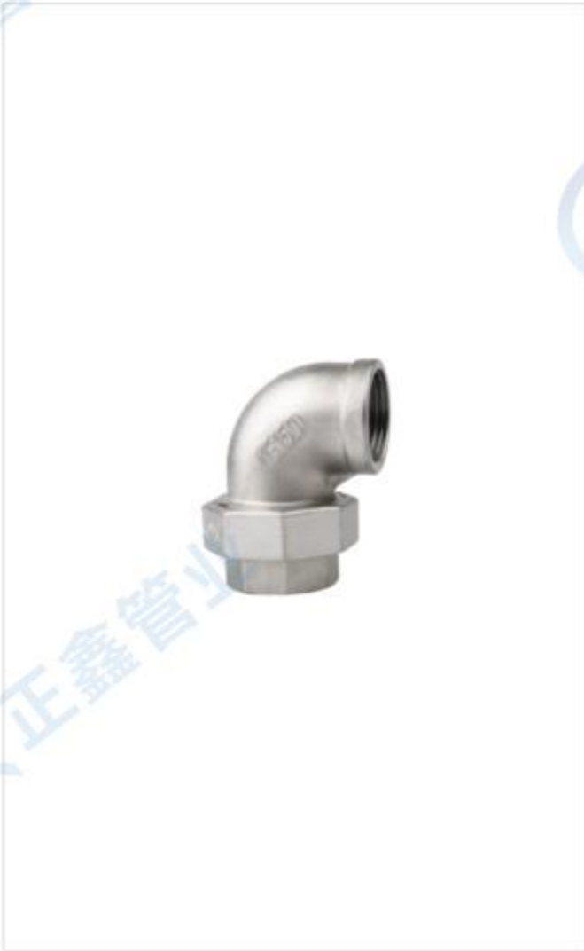
外丝活接弯头 External thread flexible joint elbow 材质:不锈钢201/304/316L/2205等 口径:1/8"-4"(DN6-DN100) 压力:PN1.6
