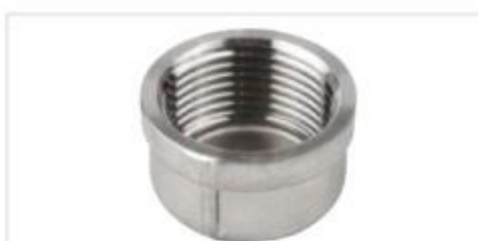
管帽 Pipe cap 材质:不锈钢201/304/316L/2205等 口径:1/8"-4"(DN6-DN100) 压力:PN1.6
