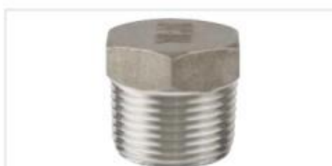
外六角塞头 Outer hexagonal plug 材质:不锈钢201/304/316L/2205等 口径:1/8"-4"(DN6-DN100) 压力:PN1.6
