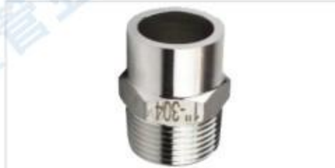
焊接外丝 Welding outer wire 材质:不锈钢201/304/316L/2205等 口径:1/8"-4"(DN6-DN100) 压力:PN1.6
