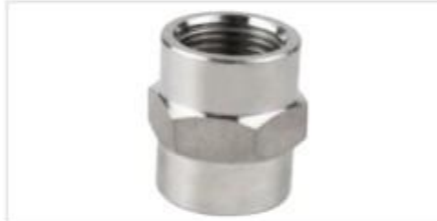
六角焊接内丝 Hexagonal welding inner wire 材质:不锈钢201/304/316L/2205等 口径:1/8"-4"(DN6-DN100) 压力:PN1.6
