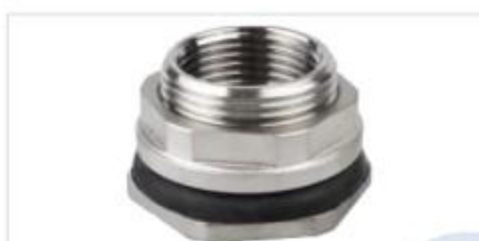
水箱接头 Water tank connector 材质:不锈钢201/304/316L/2205等 口径:1/8"-4"(DN6-DN100) 压力:PN1.6
